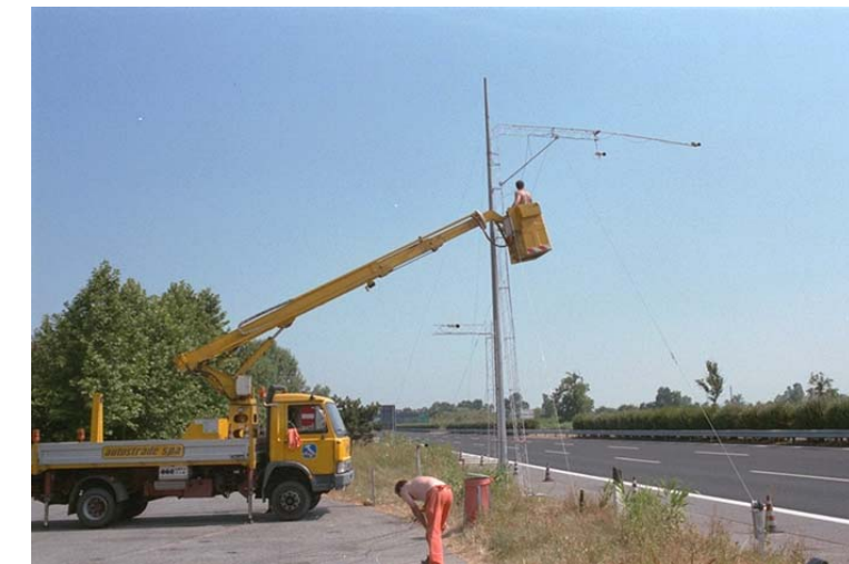
Foto 63 Sistema di array di microfoni utilizzati per la generazione della banca dati emissione dei veicoli
